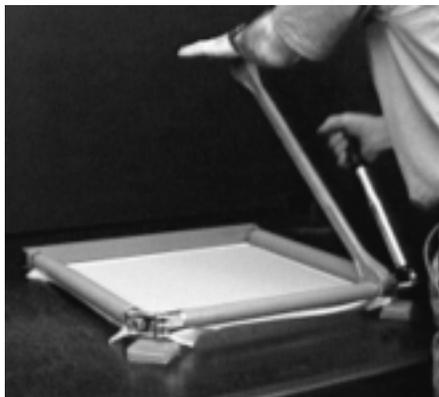
para tensar. El rodillo no girará durante este proceso de aplanamiento porque el tornillo en el otro lado del rodillo está todavía asegurado. *Si se aplica demasiada presión a la llave combinada SDI, la esquina al otro lado del rodillo se elevará.*
