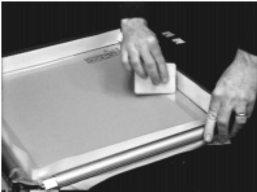
Newman Fabric Protectors™ (Protectores de Malla para los marcos Newman) son cubiertas plásticas que se fijan alrededor del rodillo o caja viga para proteger la malla. Estos no son afectados por solventes o tintas. Ellos simplemente se insertan en el rodillo o la caja viga y se mantienen en lugar con la cinta.
