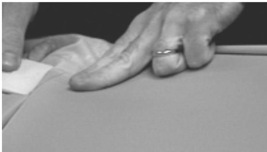
Una vez más, coloque el tensiómetro sobre la malla, en el centro del marco, para leer de acuerdo a la dirección en la que se va a retensar. Gire el rodillo hasta llegar al próximo nivel de tensión determinado por la Tabla apropiada para tensar mallas, o de acuerdo al nivel determinado por Ud. para los requerimientos de su planta. Este mismo procedimiento puede ser seguido para retensiones subsecuentes.
