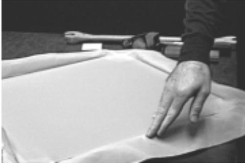
**MUY IMPORTANTE:** Antes de retensar, examinar siempre las esquinas para determinar si necesitan aflojarlas más. Si es necesario, éstas pueden ser aflojadas en este momento. (Sólo las esquinas más cercanas al rodillo que se van a girar necesitan ser aflojadas.)
