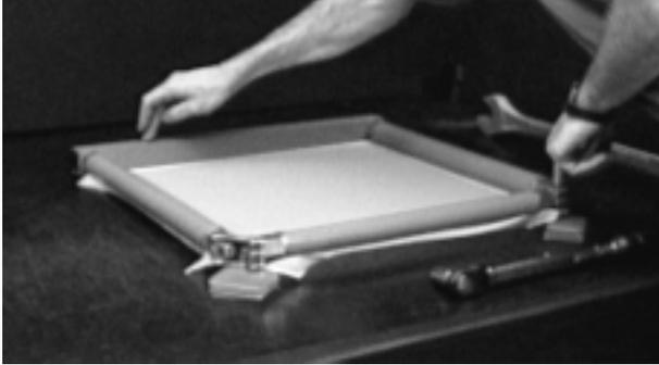
En la foto abajo, la esquina izquierda de la barra cuadrada está elevada. El marco no está plano. Vaya a la esquina diagonalmente opuesta a la esquina elevada y afloje un tornillo. El tornillo al otro lado del rodillo debe mantenerse asegurado.
