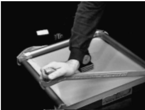
Continúe con el último rodillo #4. Antes de usar el torquímetro para aflojar el segundo tornillo de este rodillo, asegúrese de colocar la llave combinada SDI en el
